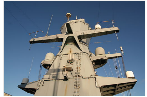
Hauptmast mit Kragen, darunter die Salinge mit Dipolen, unten die Radome
