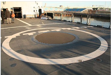
Hubschrauberdeck der Braunschweig mit Landegitter und geöffnetem Hangartor
