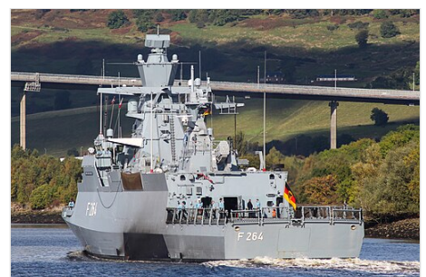
Die Ludwigshafen am Rhein mit schwarz lackierten Flächen beim Abgasaustritt über der Wasserlinie
