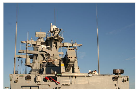
Antennenwald mit Stabantennen auf Masten; rechts im Eck der MASS-Werfer
