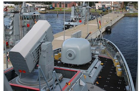
Vorschiff der Magdeburg mit vorderem RAM-Werfer (links) und Geschützturm
