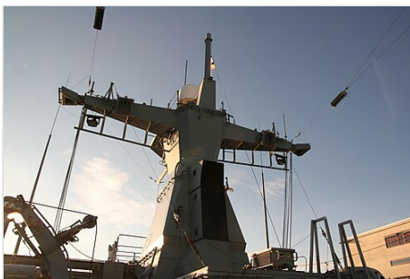
Achterer Mast mit Gitterantenne und Dipolen, dahinter weitere Stabantennen
